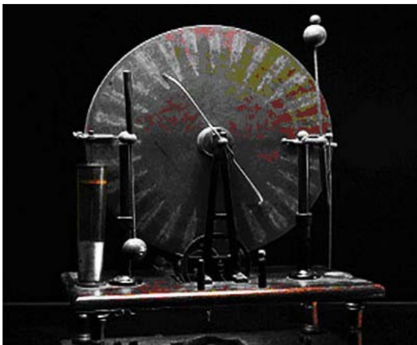
Fotografia 1: Imagem da máquina eletrostática de Wimshurst, conjunto de objetos de C&T do MCCF-UFRJ, dimensões da peça (10x40x50)cm. Fonte: Soares (2007).
